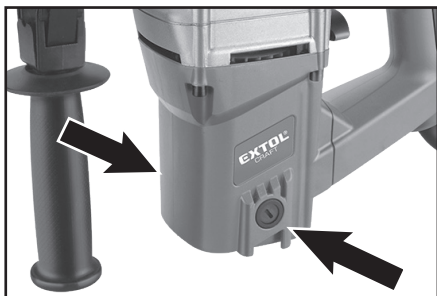
Abdeckung vom Kohlebürstengehäuse Abb. 13 beim Bohrhämmer Extol Craft 401232
